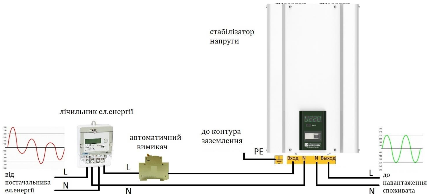
Рисунок 6. Схема підключення стабілізатора до однофазної мережі
